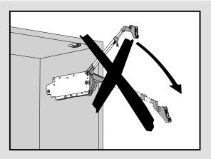
Teleskophebel nicht nach unten drücken, sondern entfernen. Do not push telescopic arm down without door attached but remove. Ne pas pousser le bras télescopique vers le bas, mais le retirer. Non spingere la leva telescopica verso il basso, altrimenti rimuoverlo. No apretar la palanca telescópica hacia abajo, si no retirarlo. Nie opuszczać podnośnika teleskopowego, lecz wypiąć. Не опускайте рычаги. В случае необходимости их следует снимать. アームを外す時は下に押さないでください。
